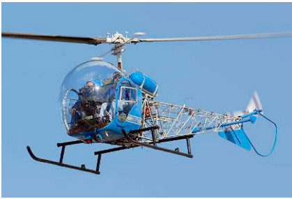
Bell 47 G (moteur à pistons Lycoming de 280 ch et rotor 2 pales). Notez la barre stabilisatrice dite "barre de Bell" du nom de son inventeur
