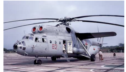
Mil Mi 6 Hook (rotor 5 pales diamètre 35 m)
