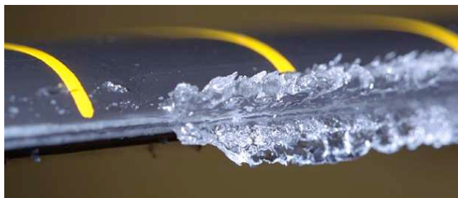
Cristaux de glace se formant sur le bord d'attaque d'une pale de rotor, dans un tunnel de givrage expérimental de la NASA.
