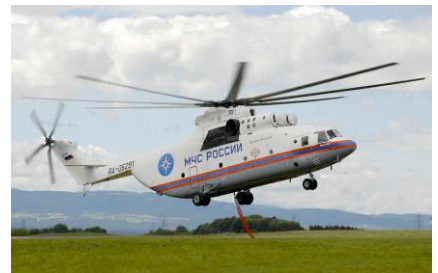
MIL MI 26T (rotor 8 pales diamètre 32 m Charge utile 40 tonnes)
