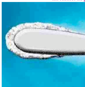
Cristaux de glace se formant sur le bord d'attaque d'une pale de rotor, dans un tunnel de givrage expérimental de la NASA.
