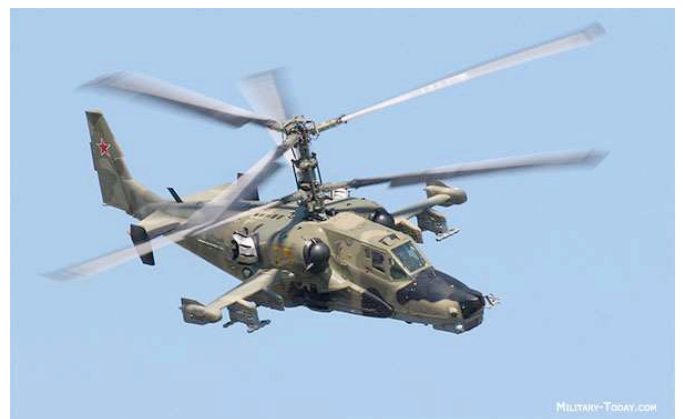
Les rotors contrarotatifs coaxiaux chez Kamov
