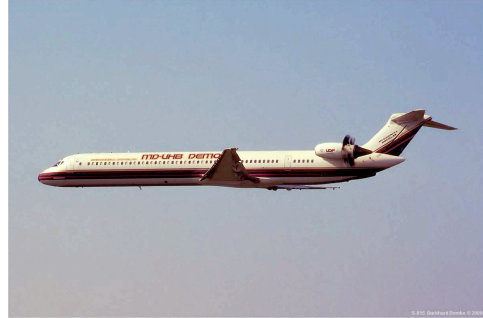
MD-81 UHB Demonstrator propfan (propulseurs)
