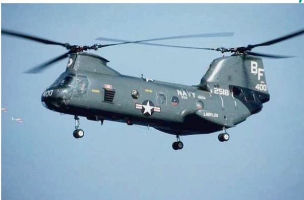
Les rotors en tandem du Vertol Sea Knight. Assez semblable au Chinook plus connu
