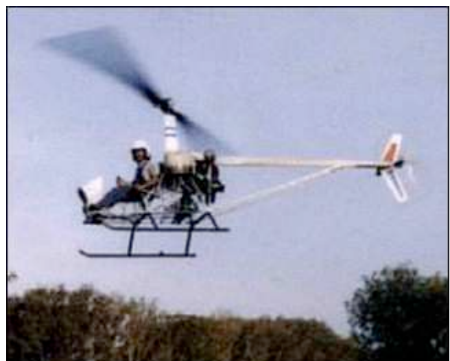
Ce Cicare CH-6 est propulsé par un Rotax 582 à pistons
