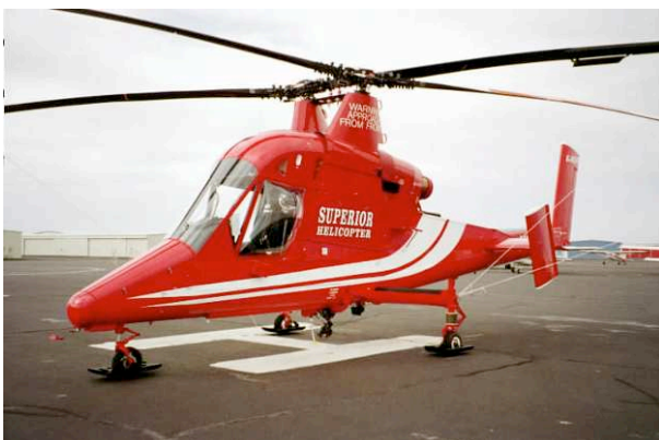
Les rotors contrarotatifs dits « engrenants » , cote a cote chez Kaman avec le K-Max
