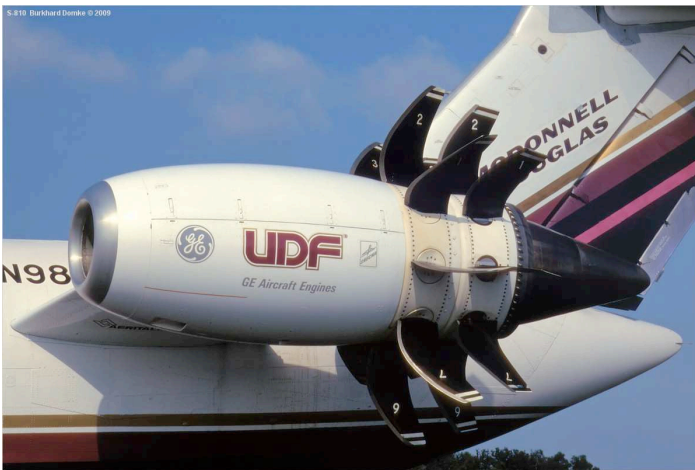
Le moteur propfan du MD-81 Demonstrator
