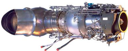
Turbine d'hélicoptère Makila (Turboméca) équipant les hélicoptères bimoteur Super Puma, Cougar et EC 725-225 d'Eurocopter
