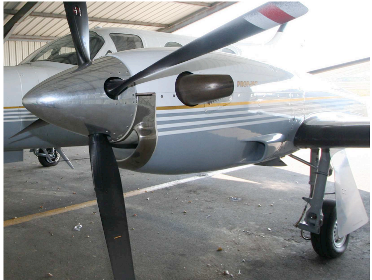
Notez le soin apporté aux capots moteurs et aux écoulements d'air. Entrée d'air moteur, casserole d'hélice, sortie d'échappement et ouïes de refroidissement.
