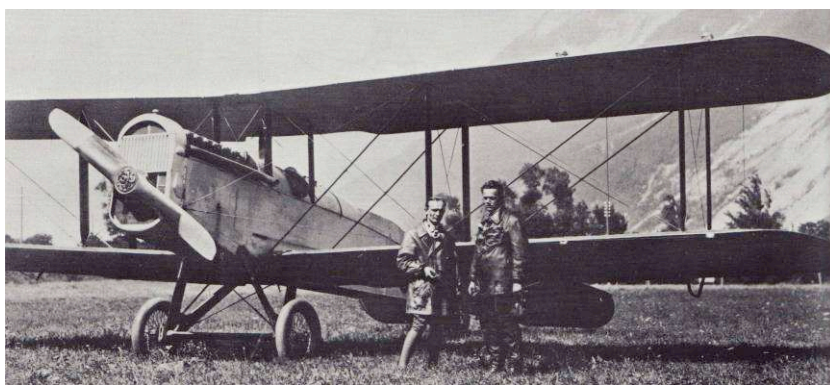
Bombardier De Havilland (DH-4) avec tir à travers l'hélice.(Observer le blindage) ↑
