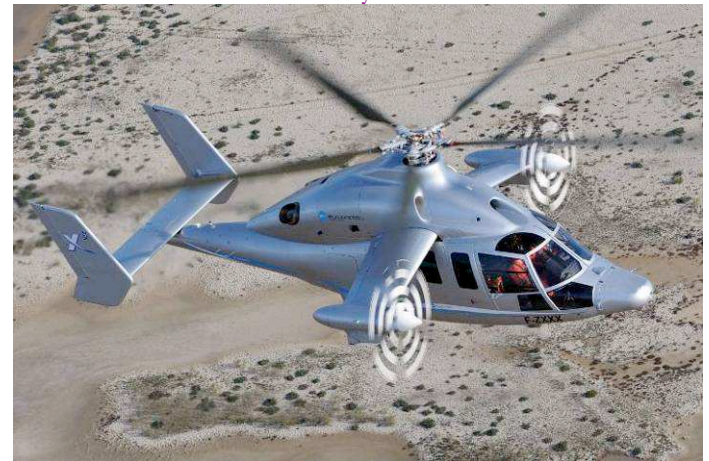
Eurocopter X3 . Cet hélicoptère est un gyrodyne puisque les mouvements verticaux sont assurés par un rotor entraîné par un moteur, comme un hélicoptère, et la traction obtenue par plusieurs autres moteurs, comme un avion.
