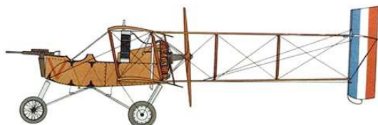
Voisin type 5 ↑ à hélice propulsive et Canon ⇨
